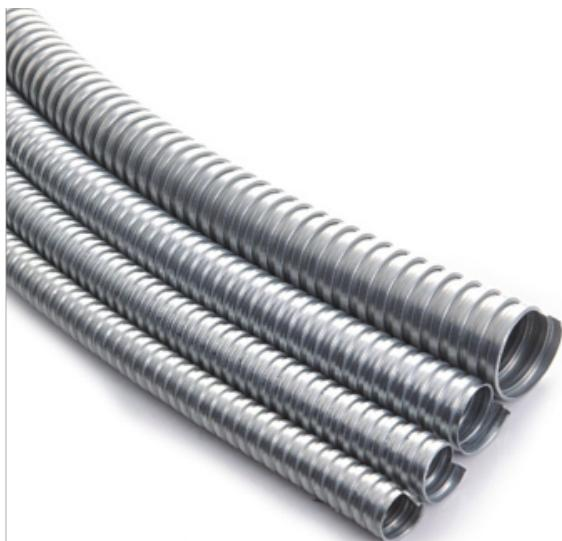
波纹管在压缩状态下工作时的允许压缩位移量比工作在拉伸状态下的允许拉伸位移量要大一些，所以在设计波纹管时应尽可能让波纹管在压缩状态下工作。通过实验发现，在一般情况下，同一材料、同一规格的波纹管，其允许的压缩位移是允许的拉伸位移的1.5倍。包塑软管用作电线、电缆、自动化仪表信号的电线电缆保护管，规格从6mm到150mm；超小口径不锈钢软管(内径3mm-25mm)主要用于精密光学尺之传感线路保护、工业传感器线路保护，具有良好的柔软性、耐腐蚀性、耐高温、耐磨损、抗拉性。
